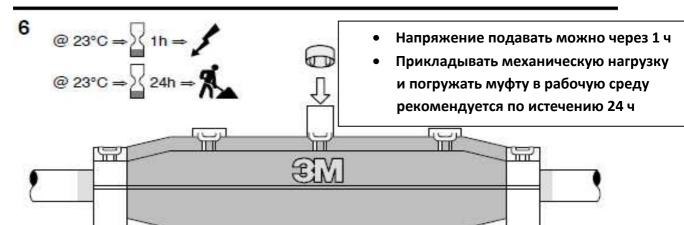
Необходимо отметить, что применяемый с муфтой электротехнический полиуретановый компаунд 3M Scotchcast™ 470 является гидрофобным и не растворяется в воде, что позволяет длительно эксплуатировать муфту в погруженном состоянии, в частности, для питания оборудования погружных насосов. В застывшем состоянии муфта обладает высокой механической прочностью при приложении как радиального, так и осевого усилия.
